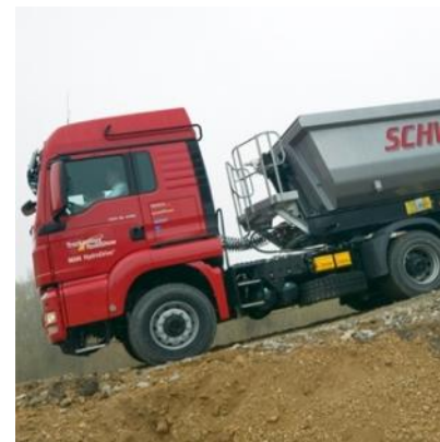
Frenata con logica su terreno non compatto per ABS e ruote bloccate
