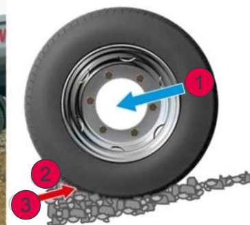
Frenata con logica su terreno non compatto per ABS e ruote bloccate
