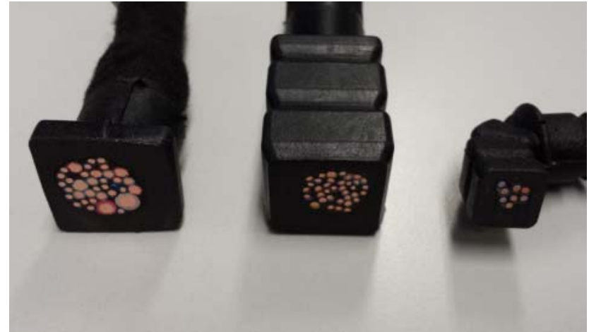
Faci di cavi colmati con espanso del motore D38
